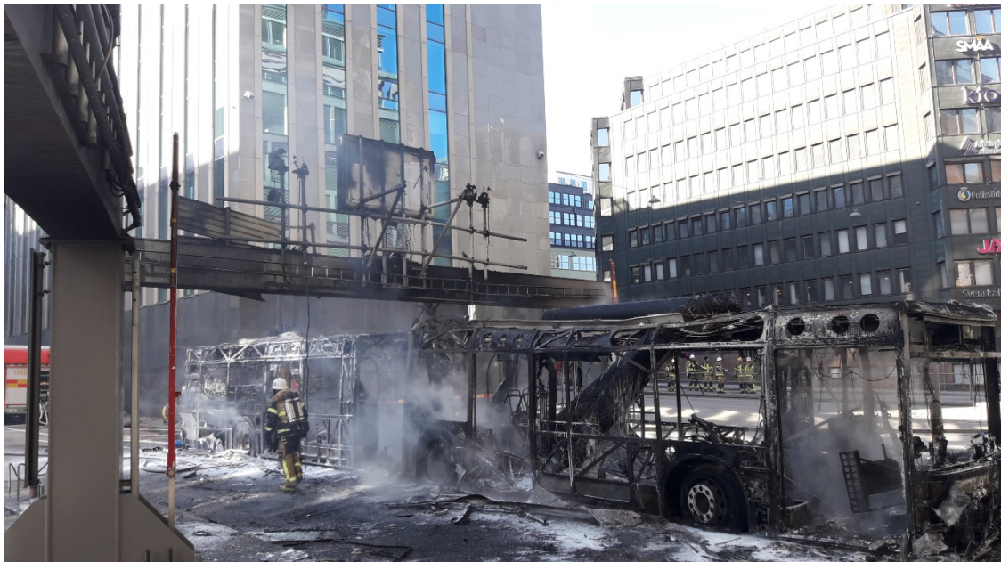
Foto 26: Två av gastankarna är kvar horisontellt på taket. Bakdelen på två av gastankarna har ramlat ner i bussen.
