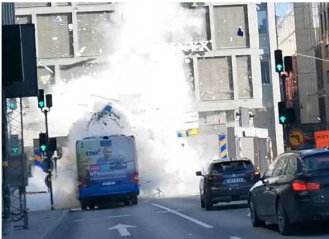
Foto 19: Gasflaskan trycks ned och åker med under inkörselskyddet. En första antydning till flammor går att se på höger sida om bussen i mitthöjd.
