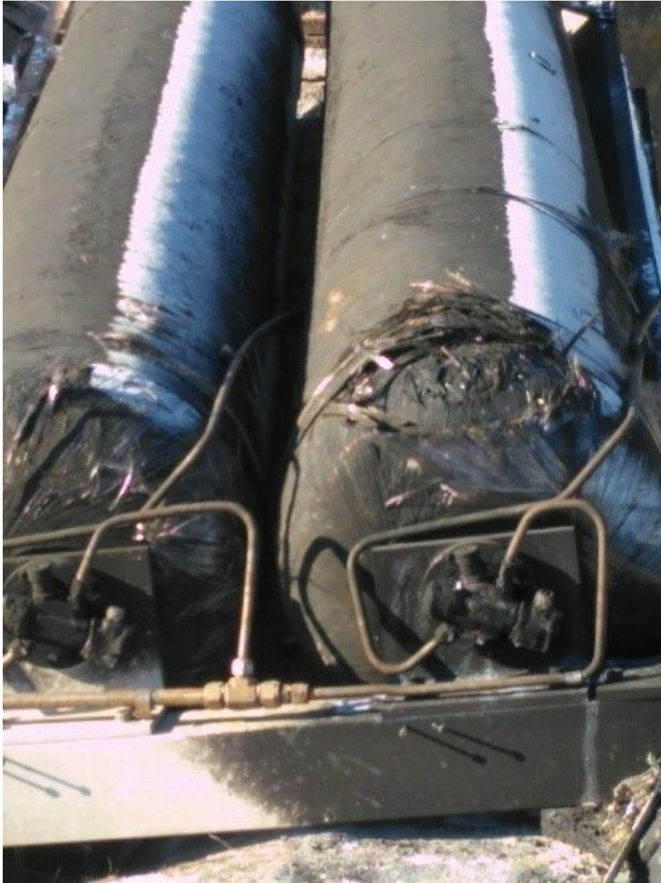
Foto 15: Gasflaskorna som sitter till vänster i färdriktning har fått skador i yttre hölj men inte penetrerats.
