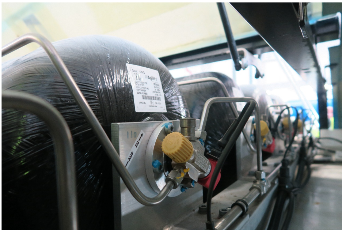
Foto 3: Framände gastank, anslutning med avstängning och smältsäkring (säkerhetsventil).
