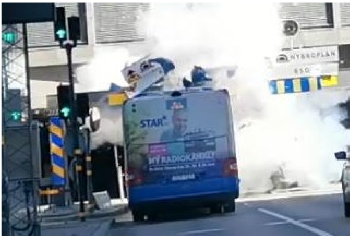
Foto 17: Bussen har kolliderat med stålbalken i inkörselskyddet. Den högra gastanken har lossnat från båda sina infästningar och gas börjar strömma ut från framänden genom ett hål i höljet.
