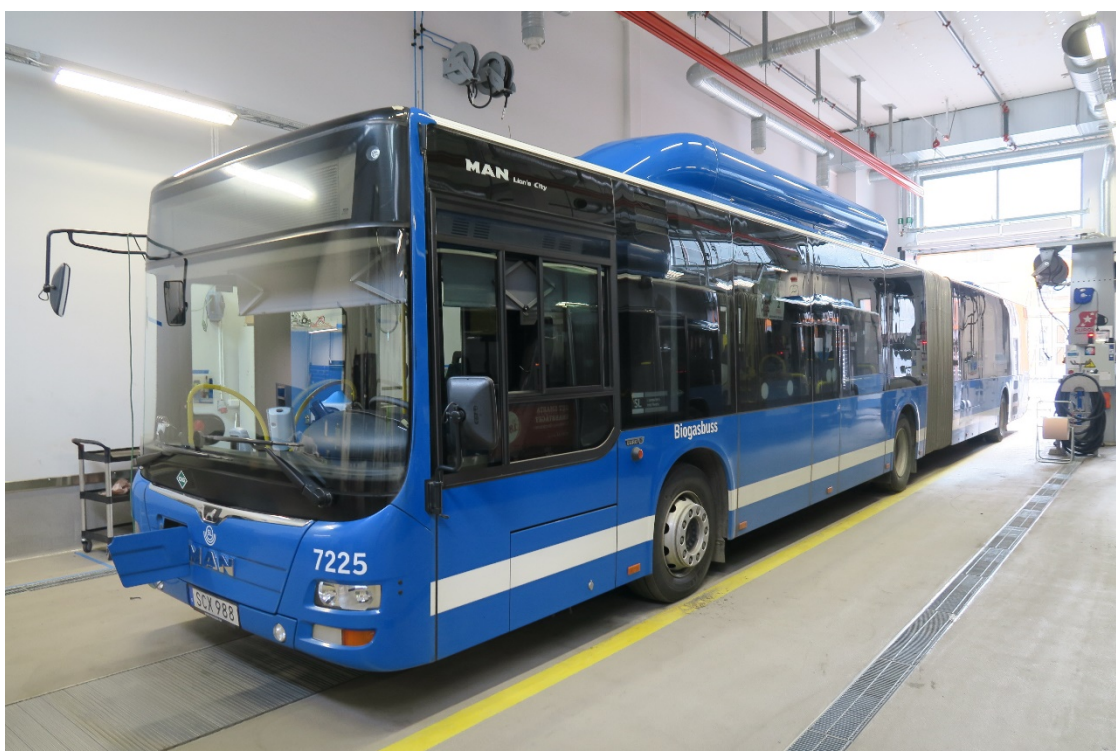
Foto 2: Gastankar monterade på taket med glasfibernkåpa över.
