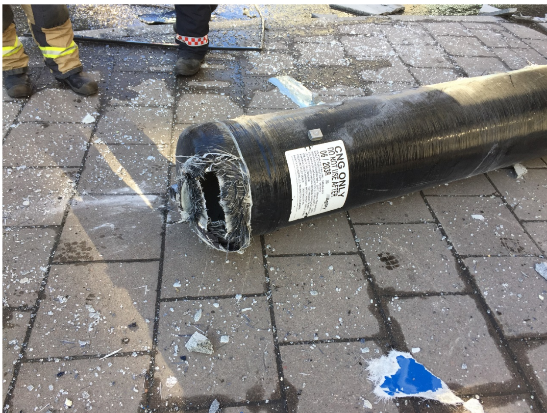
Foto 14: Gasflaskan som gick sönder vid krocken och flög iväg.
