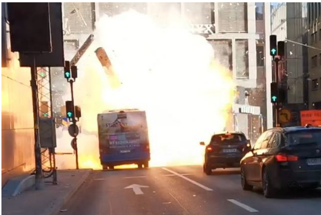
Foto 22: Reklam på bussens bakfönster börjar bli påverkad av strålningsvärmens från bussens insida.
