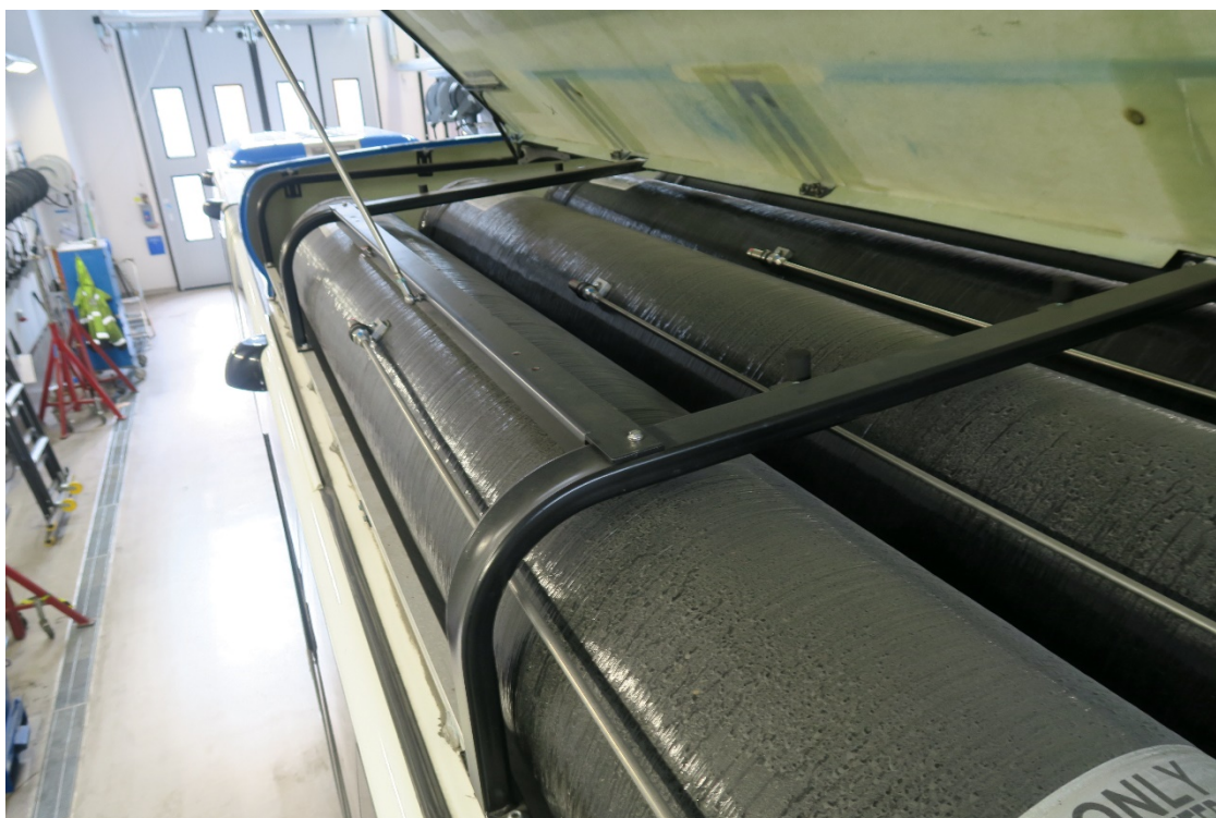
Foto 4: Gastankar med smältsäkring (säkerhetsventil) mitt på.
