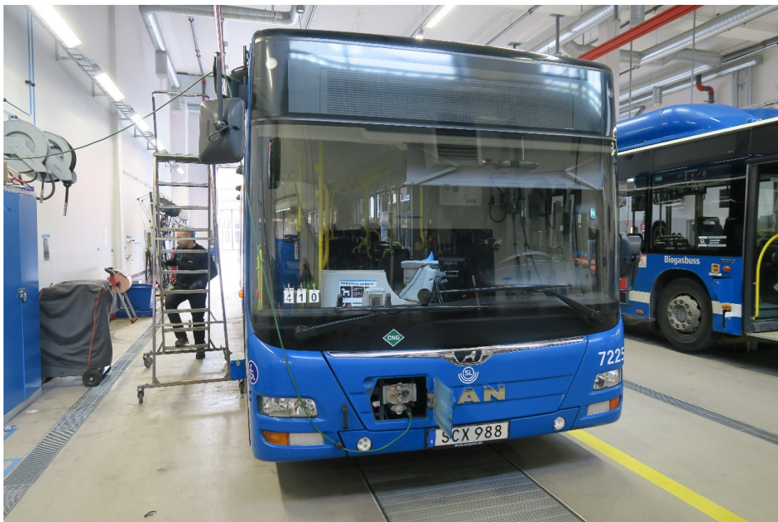
Foto 1: Buss med el tillkopplad, anslutning för luft finns bakom samma lucka i fronten. Kabel hängd på backspegel.
